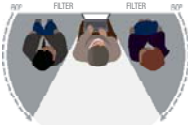
Blikken het zicht op het scherm voor iedereen behalve de gebruiker die er recht voor zit.
